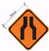
OA-21a Estreitamento de pista ao centro
