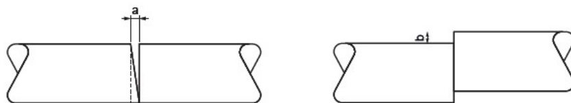
Figura 2 – Medição da fresta e do alinhamento
