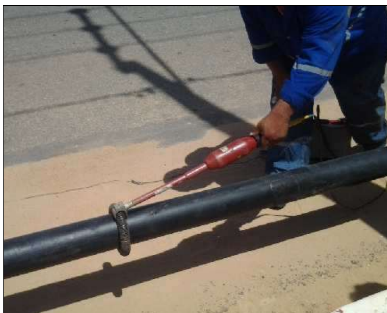
Figura 10 – Ensaio com “Holiday Detector”
