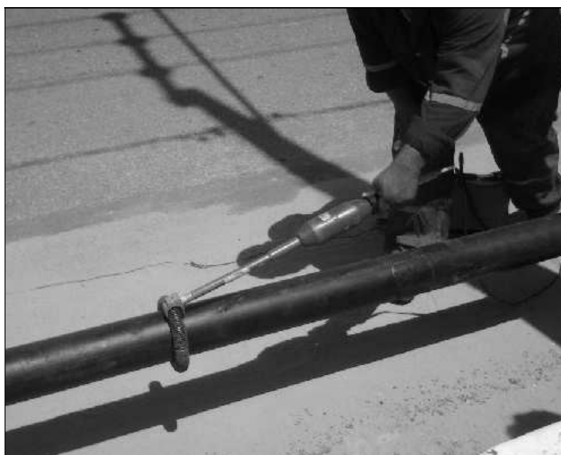
Figura 10 – Ensaio com “Holiday Detector”
