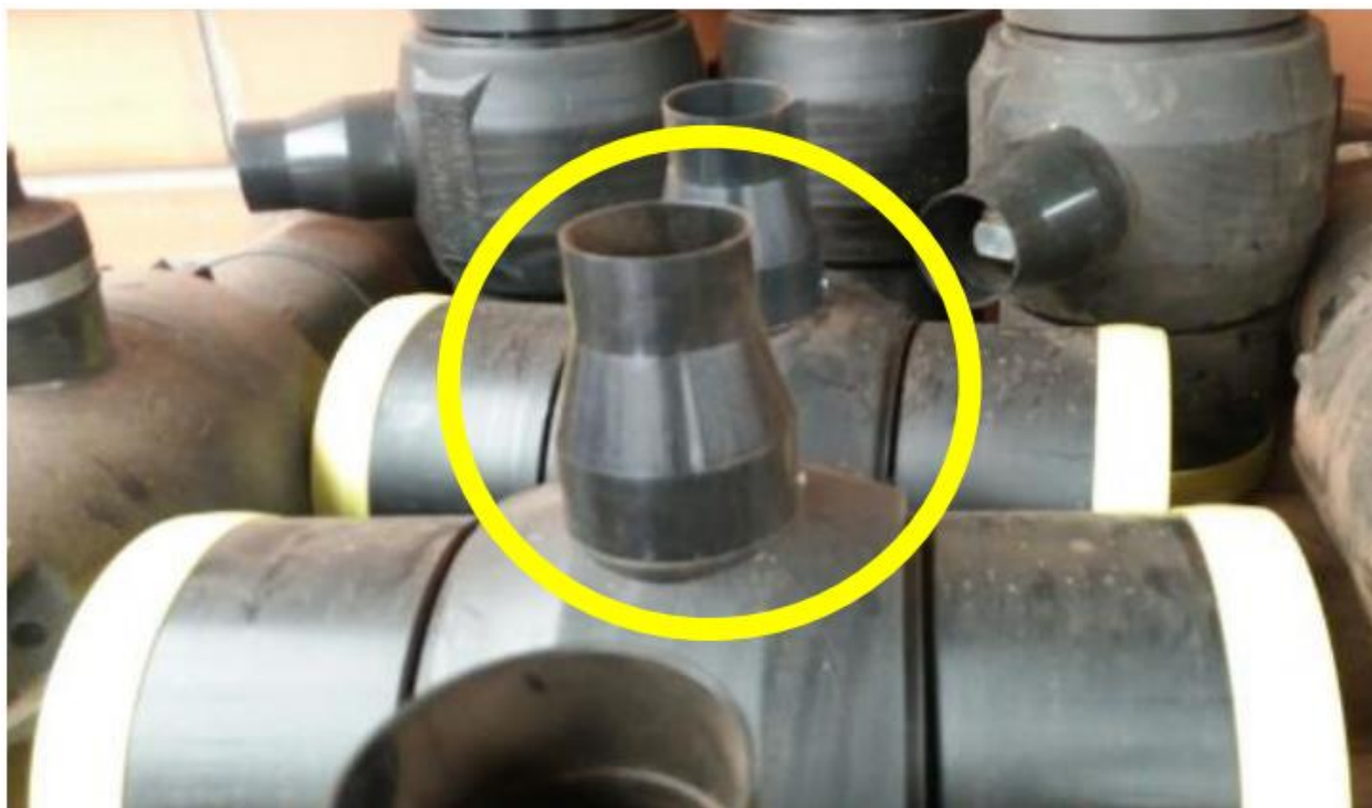
Figura 08 – Válvula com dispositivo para tubo guarda (tulipa).
